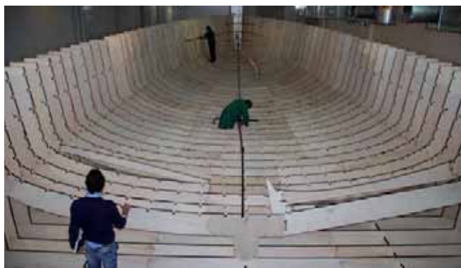
Fabbricazione dello stampo / Mould fabrication
