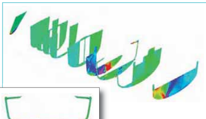
Visualizzazione delle sollecitazioni delle paratie. L'albero e le paratie della chiglia si riconoscono facilmente scaricano le sollecitazioni degli stralli di trinchetta ed i paterazzi Visualization of bulkhead stresses. The mast and keel bulkheads are easily recognised and the load recovery of chain plate fore stays and back stays
