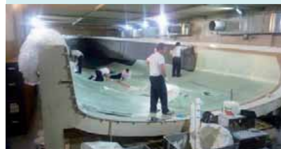
Laminazione dello scafo / Draping the hull
