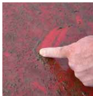
Fig. 6 - L'immagine mostra la semplicità di pulizia di una superficie protetta con Bio Flow 3000 Kit ed immersa staticamente per 12 mesi in un porto della riviera laziale The picture shows the easy to clean effect of a surface which has been treated with Bio Flow 3000 Kit, undergoing a static immersion for 12 months in a harbour of the Larian coast
