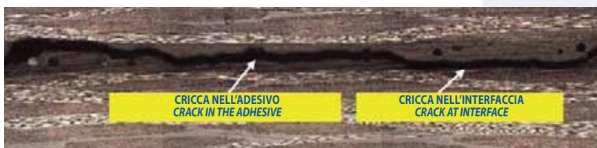
Fig. 6 - Tipica propagazione per provino DCB / Typical crack propagation for a DCB specimen
