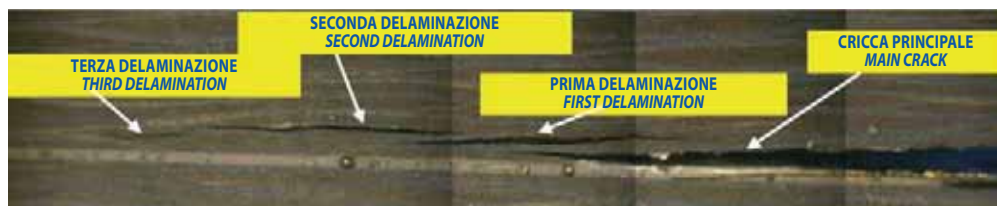
Fig. 7 - Formazione di delaminazioni per MM = 0.15 / Delaminations, Mode Mixity = 0.15
