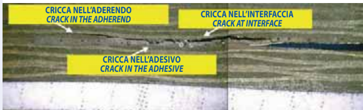
Fig. 10 - Tipica propagazione per MM = 0.5 / Typical crack propagation for Mode Ratio = 0.5
