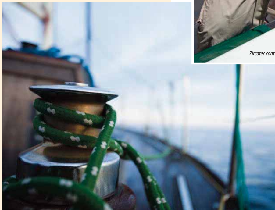
Il rivestimento dei verricelli è solo una delle varie applicazioni in cui Zircotec può operare per ottenere una superficie resistente all'usura / The coating of winches is one of several applications that Zircotec can offer an anti wear surface
