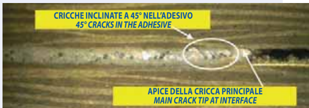
Fig. 11 - Cricche inclinate a 45° nell'adesivo, MM = 0.75 45° cracks in the adhesive for Mode Mixity = 0.75
