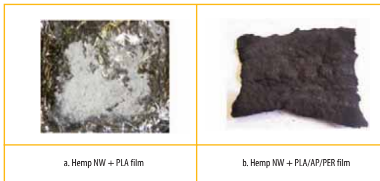
Fig. 2 Residui di (a) NW di canapa + film PLA e (b) NW di canapa + film PLA dopo aver eseguito il test della calorimetria a perdita di massa
