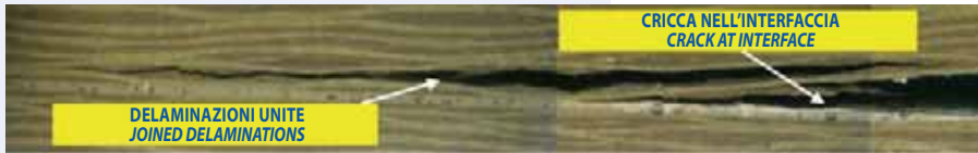
Fig. 9 - Delaminazioni unite e propagazione all'interfaccia della cricca principale, MM = 0.15 Joined delaminations and main crack interface propagation, Mode Mixity = 0.15
