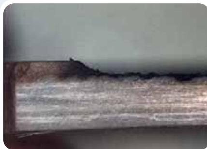
Fig. 1 Sezione trasversale di un laminato campione dopo un test della durata di 20 minuti nel calorimetro a cono, con apporto di energie da 50kW. Cross-section of a laminate sample after 20 minutes testing in the Cone Calorimeter with 50KW input compressive forces
