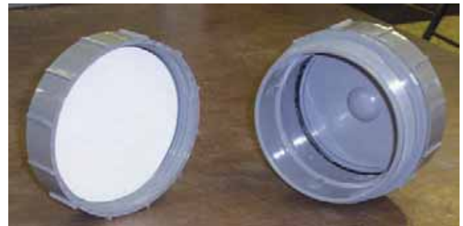
Fig. 6 - I pannelli circolari su cui è applicato il gelcoat sono posti in un container per il test del vescicamento, poi sottoposti al test per 12 mesi / Circular gelcoat panels are placed in the blister test container and then undergo 12 months of testing
