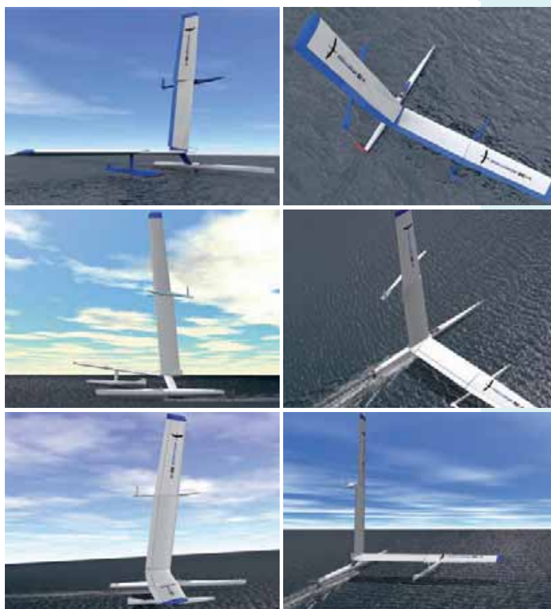
Fig. 1 Modello SolidWorks del multiscabo v-44 Albatross: viste aeree con simulazione realistica della velocità-vela per la progettazione. Notare le due vele-ala con intelaiature di sostegno; quella in posizione verticale è utilizzata come vela che cattura il vento per la propulsione della barca, mentre quella in posizione orizzontale fornisce portanza, alzando lo scafo e la chiglia dall'acqua. Inoltre, le ali-vele possono assumere altra funzione ruotando a 90° in virata. Ali-vele e chiglie sono rigidamente connesse attorno alla sezione centrale dello scafo. Per far ruotare le vele-ali e la chiglia, il pilota ritrae la carenatura di questa sezione SolidWork's model of the v-44 Albatross multihull, speed-sailing conceptual design in water-level and aerial views. Note the two wing-sails with outriggers: the one in the vertical position serves as the sail, catching the wind and powering the boat, while the one in the horizontal position provides lift, raising the hull and the keel out of the water. In addition, the wing-sails can switch function as they rotate through 90 degrees when the boat tacks. The wing-sails and keels are rigidly connected through the hull center section. To allow the wing-sails and keels to rotate, the pilot retracts a fairing that covers this section
