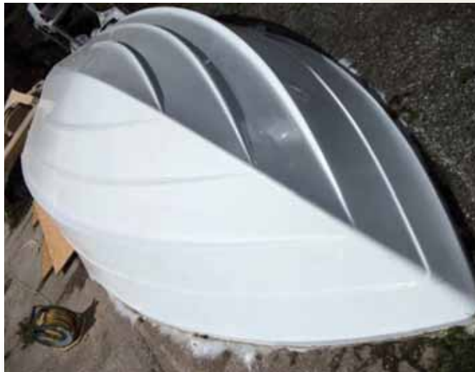
Fig. 11 - Prova Morgan Sport Boats: scafo di un'imbarcazione per sci nautico costruito con il gelcoat Crystic Permabright. Superiore brillantezza del colore bianco del gelcoat Morgan Sport Boats trial: 20 ft ski boat hull fabricated using new Crystic Permabright gelcoat. A significant improvement in gelcoat gloss and the brilliance of the white colour was noted
