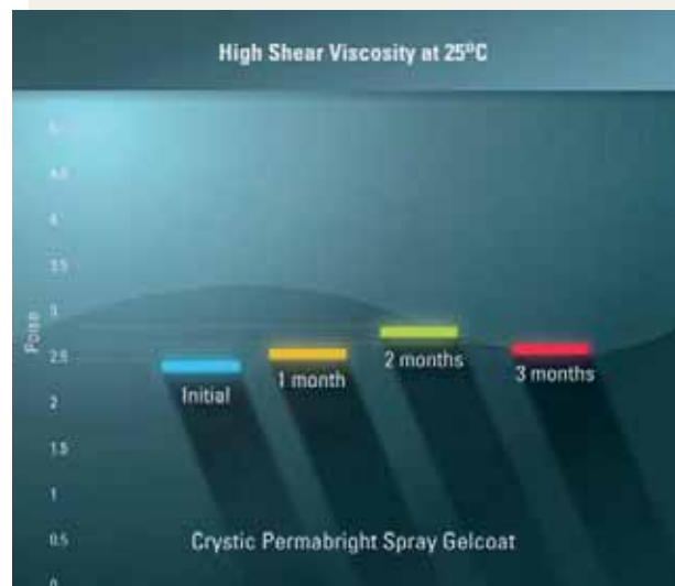
Fig. 9 - Variazioni della viscosità ad alte forze di taglio nel corso di tre mesi High shear viscosity variation over 3 months
