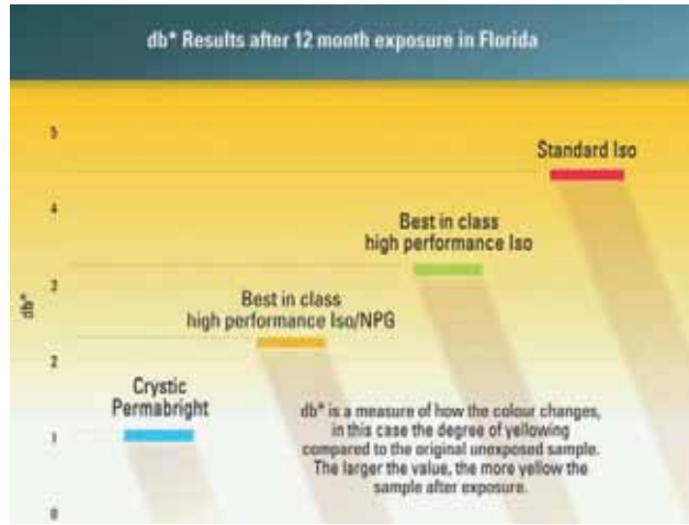
Fig. 5 - Risultati del test di esposizione naturale Delta b* in Florida per 12 mesi per la misura del grado di ingiallimento / Florida 12 Month Natural exposure Delta b* test results which measure the degree of yellowing
